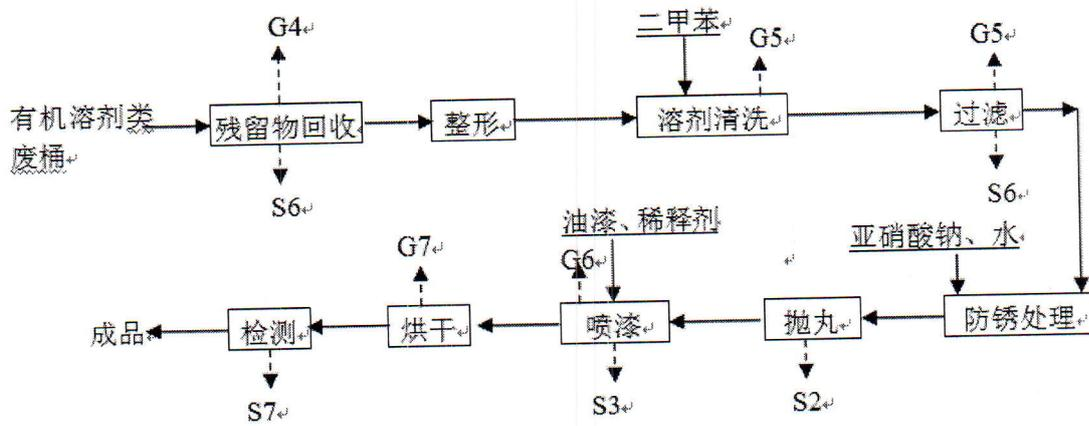
有机溶剂类废桶回收工艺流程图
