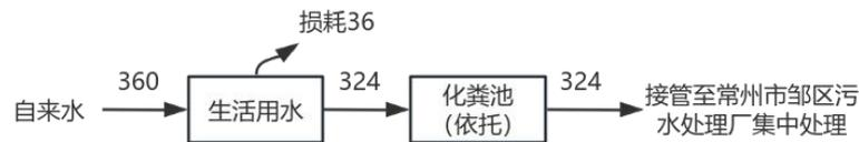
图 2-1 建设项目建成后用排水平衡图（单位：m<sup>3</sup>/a）
